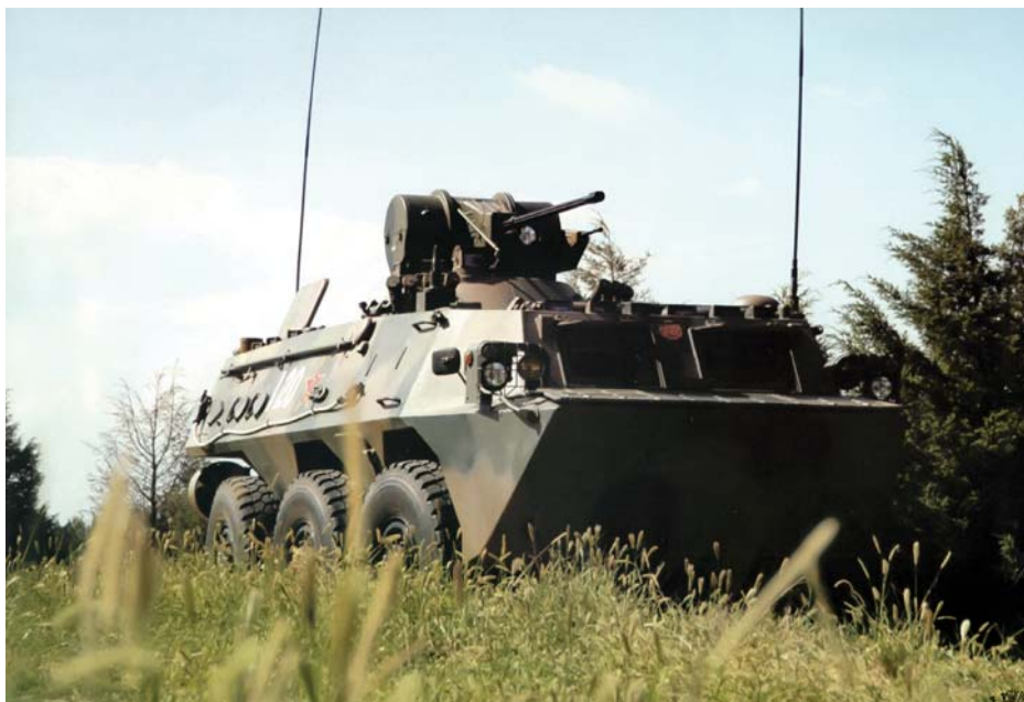
Возило ZSL-92(WZ-551A) 6x6 IFV, шoй ZPT-90 25 mm +7,62 mm, амфибија
